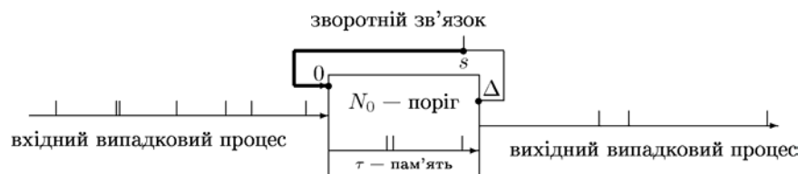
Рис. 1. Схема зв'язуючого нейрону із затриманим зворотнім зв'язком.
